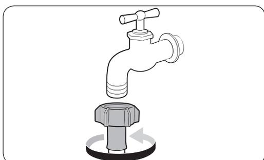
3. Maintenez l'adaptateur et tournez la **partie (C)** dans le sens de la flèche pour le desserrer de 5 mm (\*).
