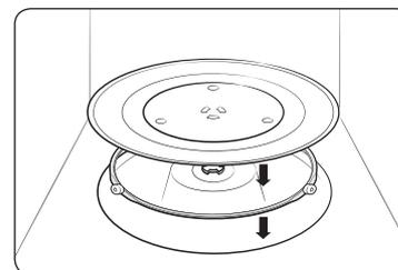
Retirez tout élément d'emballage de l'intérieur du four. Installez l'anneau de guidage et le plateau. Vérifiez que le plateau tourne librement.
