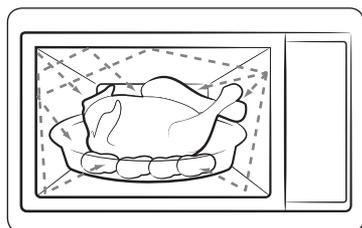
1. Les micro-ondes générées par le magnétron sont réfléchies sur les parois du four et réparties de façon homogène à l'intérieur du four pendant la cuisson grâce à la rotation du plateau sur lequel sont placés les produits. Ce procédé assure donc une cuisson homogène des aliments.
